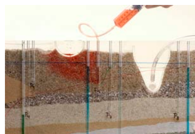
Sickerwasser aus einer undichten Deponie verunreinigt die Grundwasserfassung.
