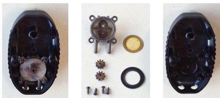
Die 4 Schrauben des Pumpengehäuses lösen. Den Deckel umdrehen und die zwei Zahnräder herausnehmen. Die Metallscheibe und die Gummidichtung aus der Schale nehmen.
