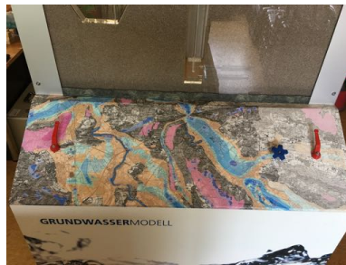
Frontseite: Grundablass (rot) in der Stellung «offen»
