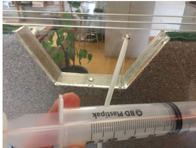
Farbinjektion mit Spritze bei Fluss
