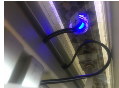
... LED mit Abschirmungsrohr aus Alu
