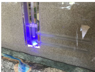
beleuchteter Schacht mit horizontalen Filtersträngen
