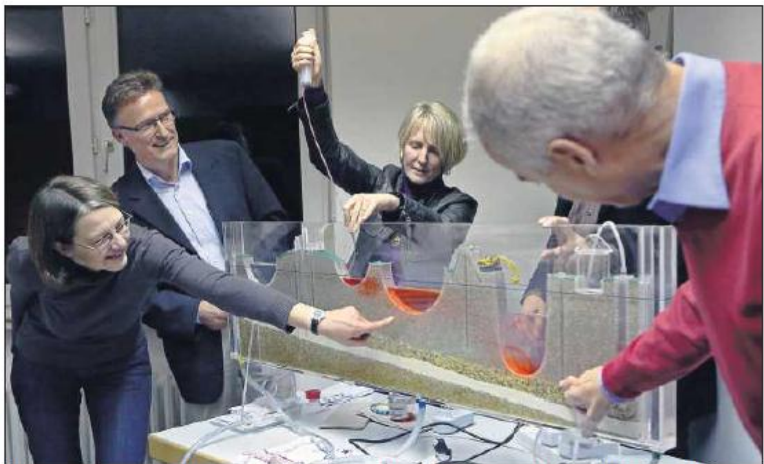
Roter Farbstoff zeigt, wie sich Verunreinigungen im Ernstfall verteilen. Das Modell soll vor allem für den Unterricht verwendet werden.
